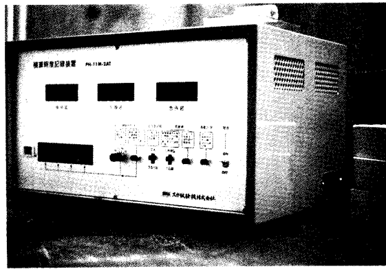
写真3. 積算照度計 (記録部)
