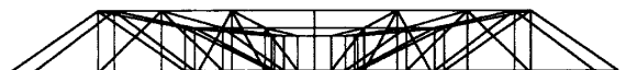
図13 支柱を垂直にしたときの初期形状解析のデータ (Side View)
