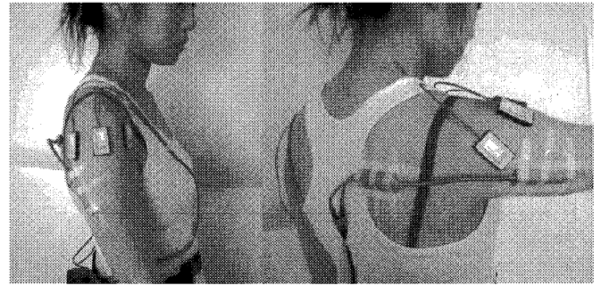
図4 筋電図用電極と関節角度計の装着
