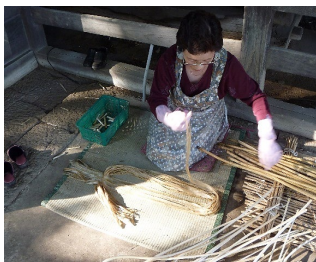
麻剥ぎ：発酵させた表皮を茎から剥ぎ取り、昔ながらの麻挽の道具を使って手作業で繊維細胞以外を除去
