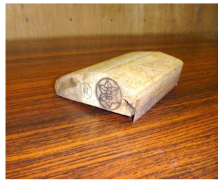
麻剥ぎ：発酵させた表皮を茎から剥ぎ取り、昔ながらの麻挽の道具を使って手作業で繊維細胞以外を除去
